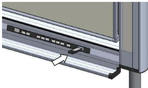
5. 『美撮る』前面の操作パネルの『電源』『こく』キーを押しながら、主電源を投入します。
