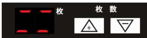
6. 表示が切り替わりソフトウェア更新をお知らせします。更新が完了するまで数分お待ち下さい。更新中は、インジケータはイラストの通り表示が変化します。
