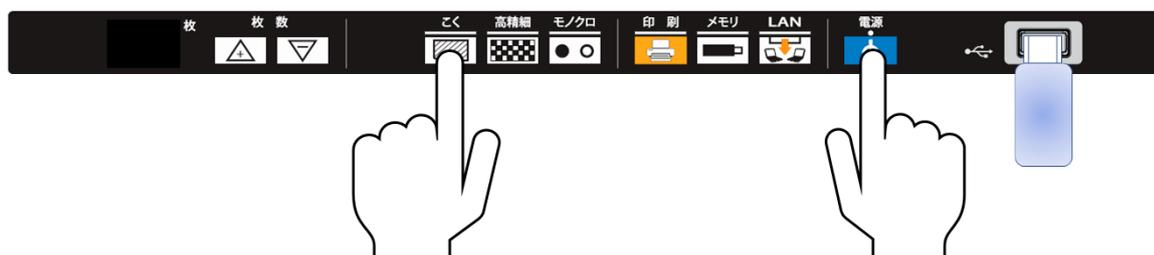
前面の操作パネルにある『枚数』インジケータランプがイラストと同じパターンに点灯表示になるまで『電源』『こく』キーを押し続けます。イラストと同じパターンになったら手を放してください。
